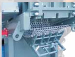
Masívne **výklopné lôžko** umožňuje spoľahlivé upevnenie sita, jeho rýchlu a jednoduchú výmenu
