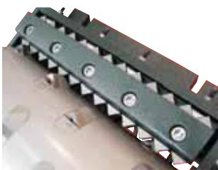
Nástroje majú tvar doštičiek štvorcového prie-rezu a pomocou držiakov sú pripojené k rotoru. Dajú sa otáčať, takže sa môžu postupne využiť všetky štyri ostria. Nastaviteľný protinôž je pevne pripojený k stene drviacej komory
